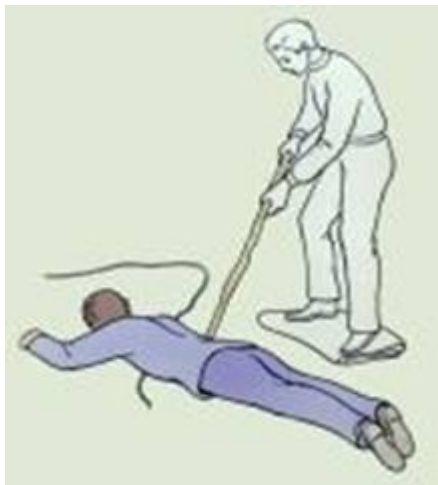
Рис.1. Відсунення потерпілого від джерела електричного струму за допомогою сухої палиці.
